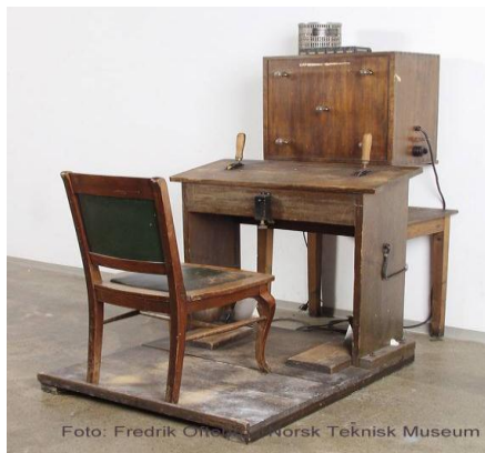
Figur 4. Testapparat kjøpt inn fra Tyskland rundt 1930-tallet av Psykoteknisk institutt i Oslo, blant annet for å teste reaksjonsevnen til tog- og trikkeførere.
